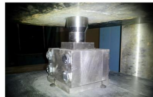
Формування бетонного кубика під тиском на пресі у лабораторії Національного університету "Львівська політехніка" Формирование бетонного кубика под давлением на прессе в лаборатории Национального университета "Львовская политехника"
